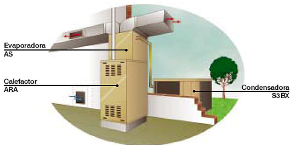
SISTEMA CENTRAL FRÍO-CALOR CON CALEFACCIÓN A GAS
