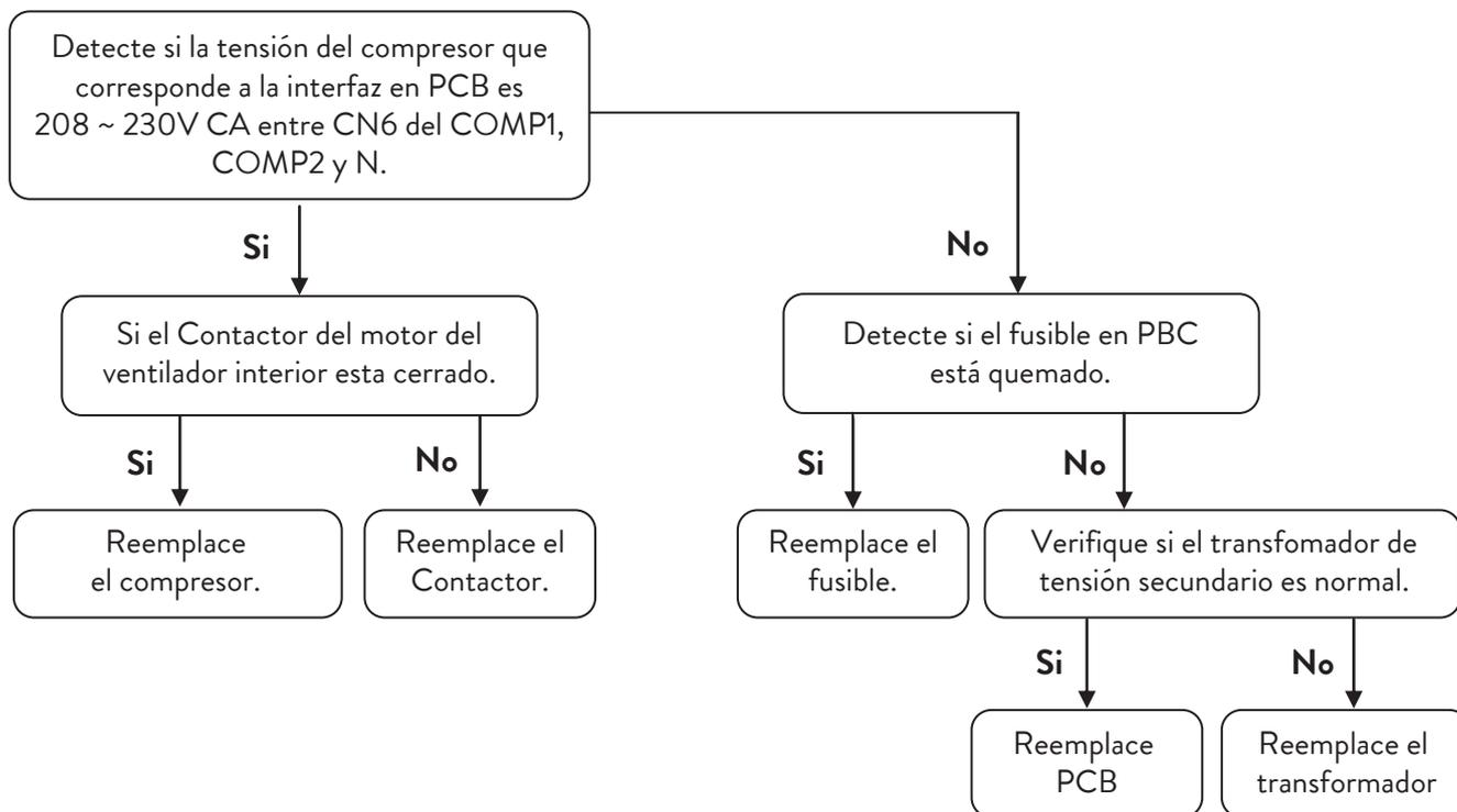
**3) Error del sensor de temp. T3**
