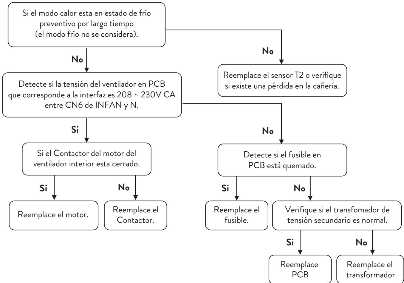
**2) El compresor no funciona (La conexión de todos los cables es correcta y confiable, si el suministro de energía es el rango requerido. Si el compresor no funciona, Ud. puede analizar lo siguiente)**
