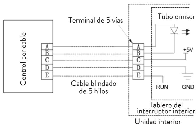
Cuando se necesite un control por cable, se deberá agregar un terminal pequeño de 5 vías, fijar un emisor infrarrojo con una pistola de agua cerca al receptor en el tablero central. Conectar el ánodo y cátodo a A y B, y +5V, GND, RUN, a C, D, E en el tablero central.
