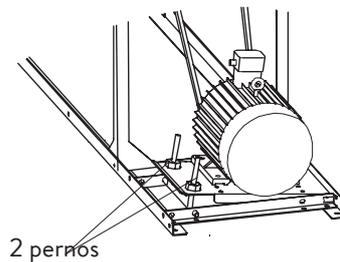
Los dos pernos se utilizan para el ajuste preciso.
