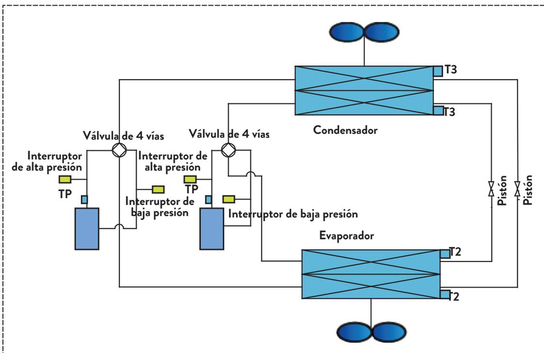
TP: Sensor de temperatura de descarga del compresor en el sistema.
