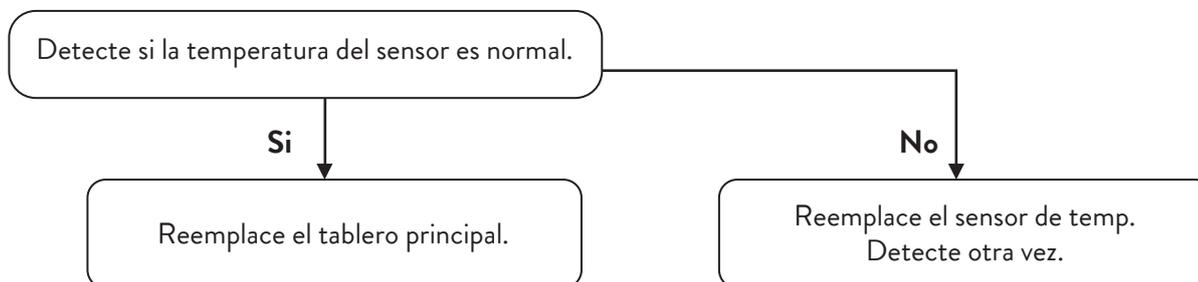
4) Cuando se visualiza E2, E5, E6 o EA, por favor verifique la placa de identificación del cableado, si los terminales T2\_1, T2\_2, T3\_2, T4 están conectados a un circuito corto. Si no sucede eso por favor conecte todo a un circuito corto a menos que reemplace el tablero principal
