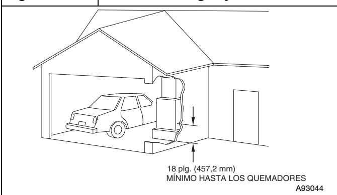
Figura 4 Instalación en garaje
