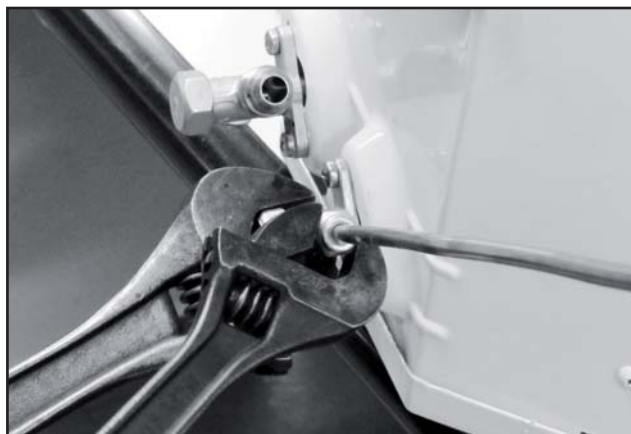
FIGURA 31 - FIJACIÓN DE LA TUERCA
